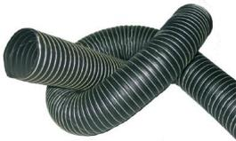
Gaine flexible constituée d'une couche en tissu de verre enduit de néoprène sur une armature intérieure en fil d'acier et d'une cordelette en fibre de verre sur l'extérieur.
